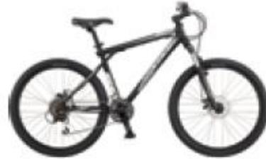
Sur ces modèles le guidon est plat, les pneus crantés, le cadre épais. Certains ont une fourche à suspension et d'autres ont aussi un système de suspension à l'arrière. Ces caractéristiques rendent les VTT plus lents sur route.
