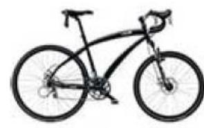
Il s'agit d'un croisement entre le vélo de course et le VTT. Ils ont en général un guidon droit et des pneus semi-lisses, mais le cadre est différent d'un VTT et on se tient moins courbé. Le système de suspension est également moins important que sur un VTT mais ces vélos peuvent être lourds.
